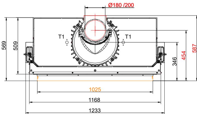
... Anbaurahmen und Wärmetauscherringe Guss + Gusskuppel
